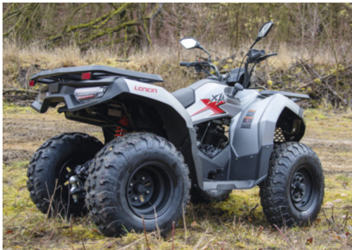
Der Einfachheit halber: Starre Achse, simples Fahrwerk, sehr griffige Reifen.
