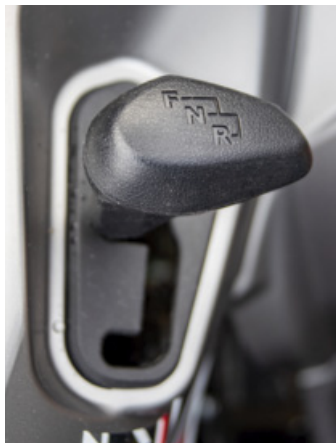
Das muss reichen: Drei Fahrstufen halten den Einzylinder im lockeren Trab bis 60 km/h.
