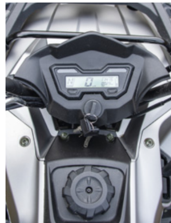
Simplex: Der Arbeitsplatz ist überschaubar, die Instrumente eindeutig. Kleiner Digitaltacho reicht aus.
